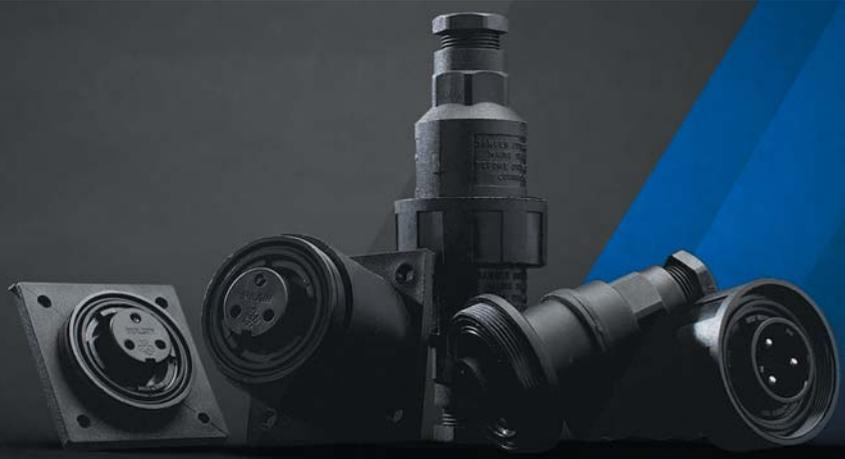
сертификатами. Степень защиты IP68 в соответствии с требованиями IEC означает, что разъемы полностью защищены от проникновения пыли и могут быть постоянно погружены в воду. Положительно завершённые испытания заключались в погружении разъема на глубину 10 м на две недели, а также на 100 м в течение 12 ч. Ни в одном из случаев не было установлено попадание воды в разъем.
