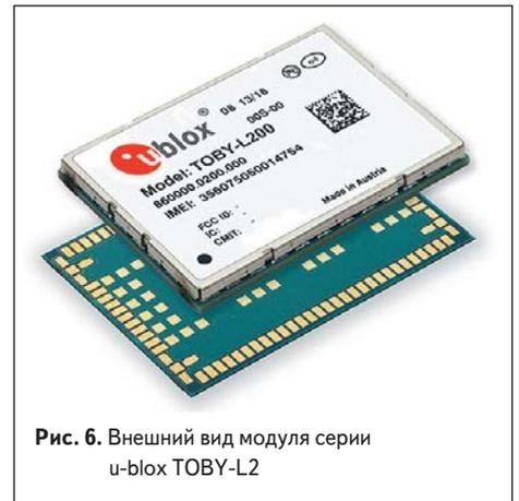
Рис. 6. Внешний вид модуля серии u-blox TOBY-L2
