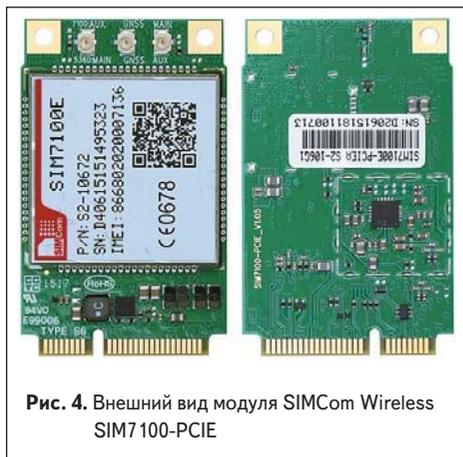
Рис. 4. Внешний вид модуля SIMCom Wireless SIM7100-PCIE
