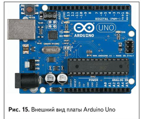
Рис. 15. Внешний вид платы Arduino Uno
