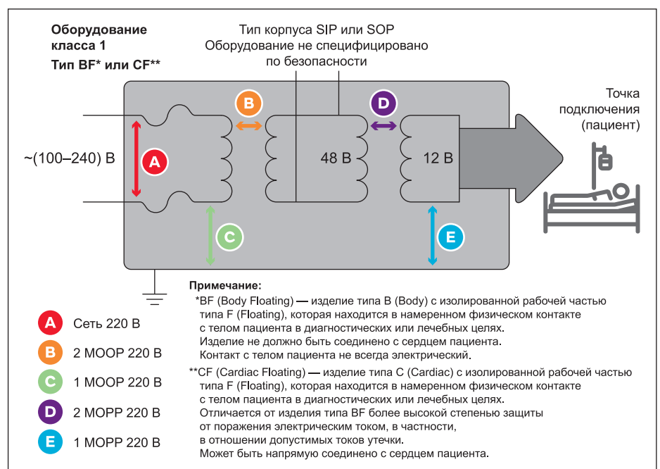
Рис. 3. DC/DC-преобразователи защищают оборудование от отказов внешнего оборудования
