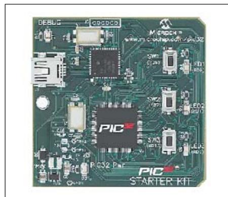
Рис. 2. Отладочная плата PIC32 Starter Kit
