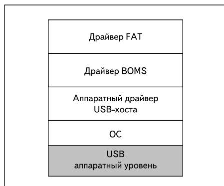
Рис. 4. Иерархическая структура драйверов для работы с USB-накопителями
