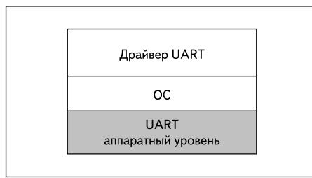
Рис. 5. Иерархическая структура драйверов для работы с интерфейсом UART
