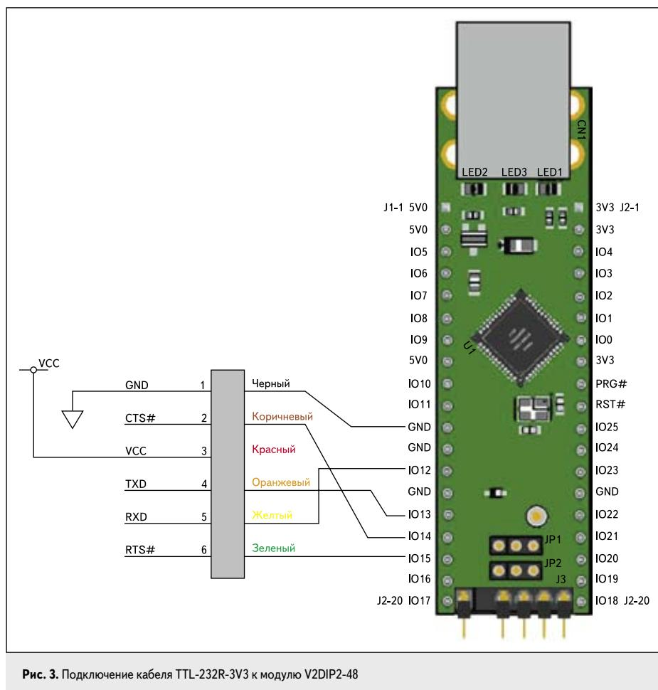
Рис. 3. Подключение кабеля TTL-232R-3V3 к модулю V2DIP2-48
