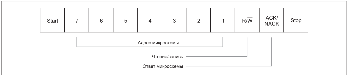
Рис. 5. Структура передачи пакета данных от ведущего устройства
