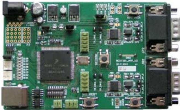
Рис. 4. Ознакомительная плата NCV73812037EVБ на базе трансивера NCV7381
