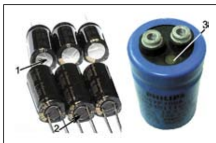
Рис. 4. Пути дренажа электролита в алюминиевых конденсаторах: 1 — специальная насечка, ослабляющая дно алюминиевого стакана; 2 — пластмассовая или резиновая пробка, закрывающая стакан и фиксирующая выводы; 3 — клапан в конденсаторах большой емкости
