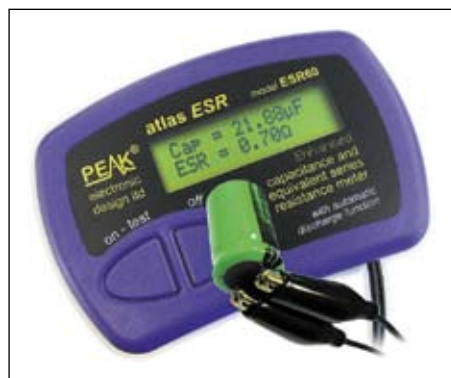
Рис. 8. Популярный прибор типа ESR60 для измерения емкости и эквивалентного последовательного сопротивления (ЭПС)
