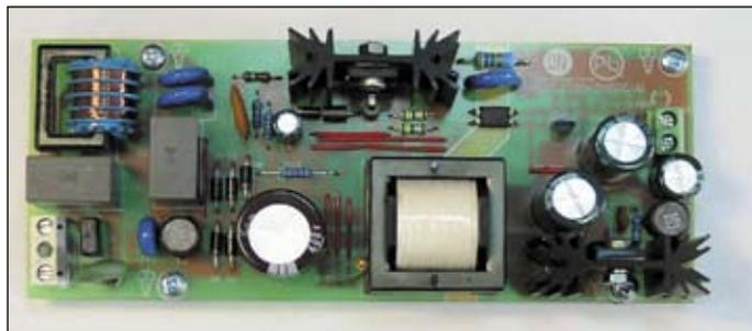
Рис. 7. Фотография разработанного прототипа (реальные размеры 143×57,6 мм)
