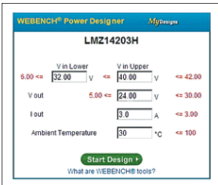
Рис. 3. Окно запуска системы проектирования WEBENCH Power Designer
