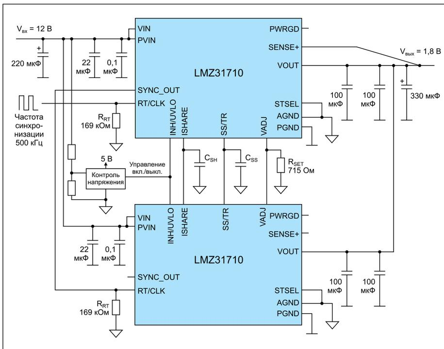
Рис. 3. Схема включения модулей LMZ31710 в параллельном режиме
