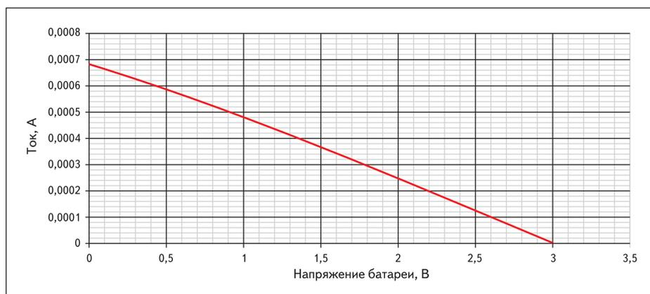
Рис. 6. Зависимость тока заряда от напряжения батареи
