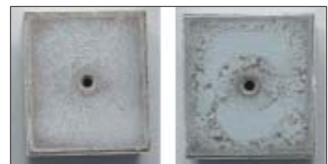
Рис. 11. Толщина слоя: а) оптимальная; б) недостаточная
