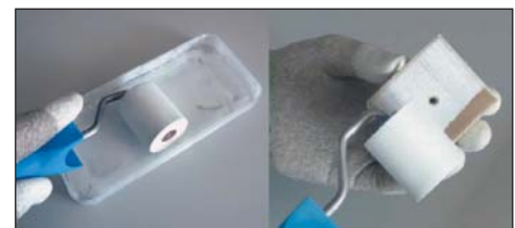
Рис. 5. Нанесение пасты с помощью резинового ролика
