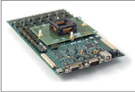
Рис. 9. Базовый отладочный комплект ATSTK600
