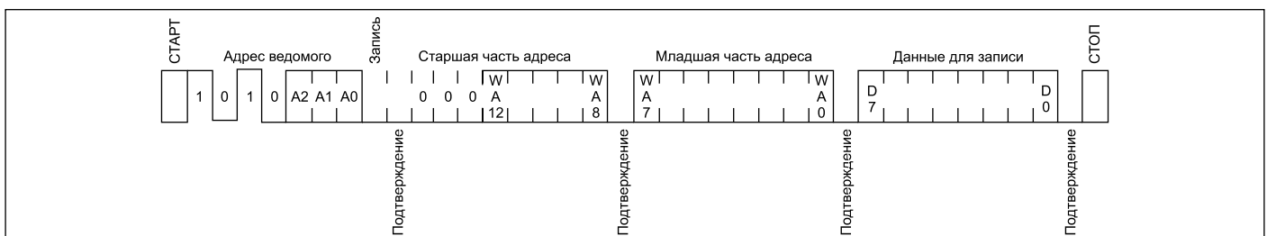
Рис. 6. Последовательность битов при выполнении записи
