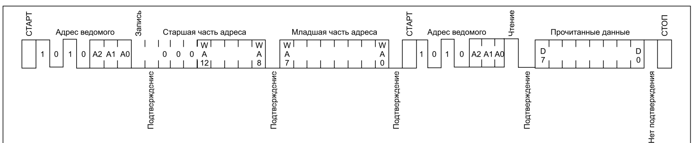
Рис. 7. Последовательность битов при выполнении чтения
