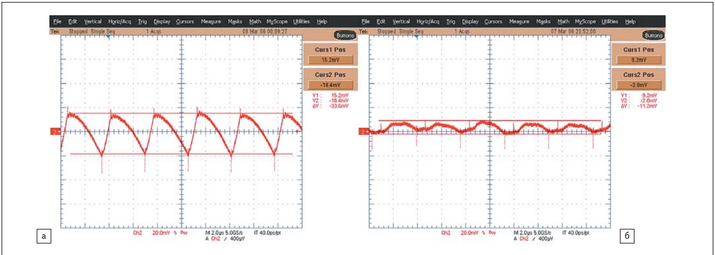
Рис. 7. Графики пульсаций: а) в обычном режиме; б) в режиме Emulated Ripple Mode
