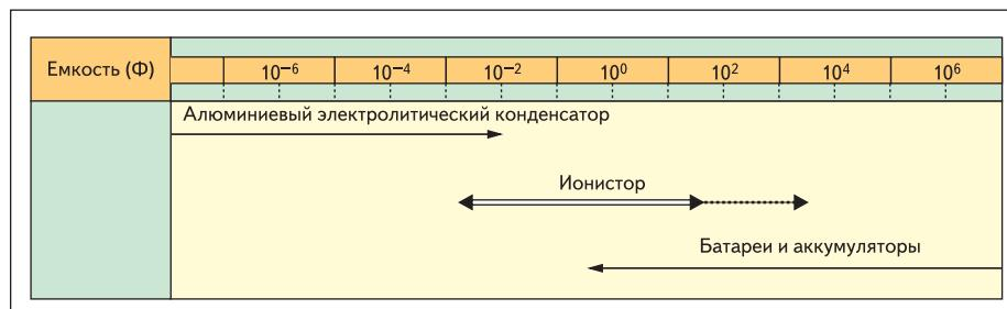
Рис. 10. Диапазон емкостей ионистора, алюминиевого электролитического конденсатора, аккумуляторов и батарей
