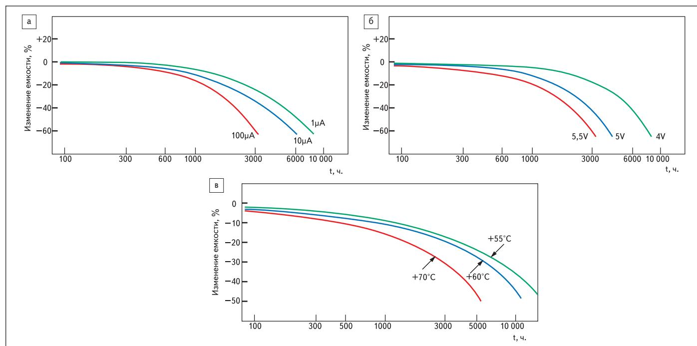
**Рис. 16.** Зависимость между током разряда (а), приложенным напряжением (б), температурой (в) и изменением емкости для EECF5R5U104 (5,5 В, 0,1 Φ). Условия измерения: 5,5 В, +70 °C
