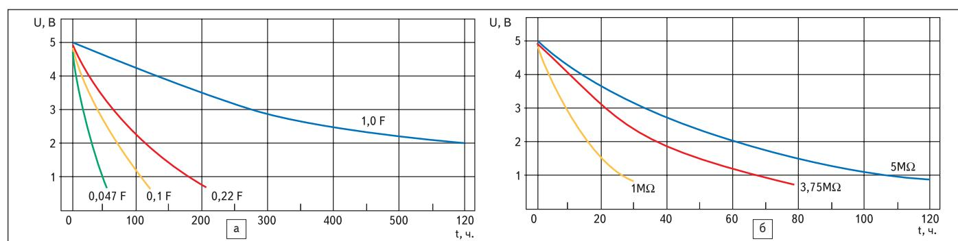
**Рис. 14.** Характеристика разряда для ионисторов различной емкости при сопротивлении 1 МΩ (а) и в зависимости от сопротивления для EECS0HD473V (5,5 В, 0,047 Φ) (б). Условия заряда: 5 В, 24 часа, +20 °C
