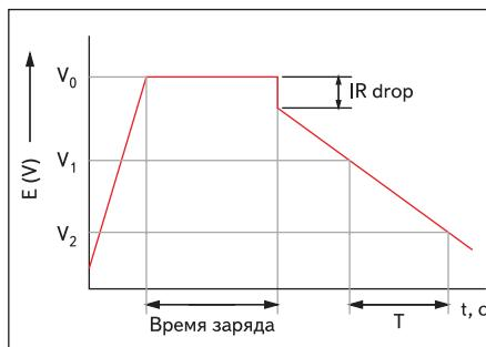
**Рис. 8.** Зависимость напряжения для ионистора от времени
