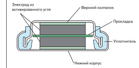
Рис. 3. Одна из возможных конструкций ионистора в поперечном разрезе на примере EN серии Panasonic
