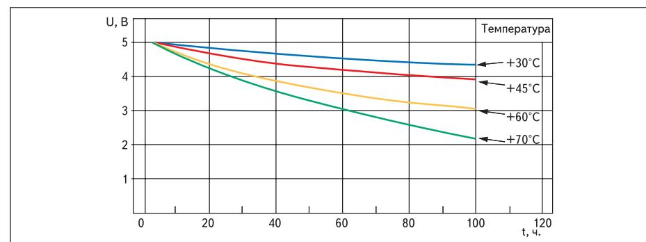
**Рис. 13. Характеристика саморазряда в зависимости от температуры для EECS0HD104V (5,5 В, 0,1 Ф)**
