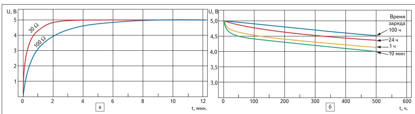
**Рис. 12. Характеристика заряда (а) и саморазряда (б) для EECF5R5U105 (5,5 В, 1,0 Ф) при +20 °C**
