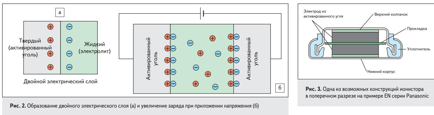
Рис. 2. Образование двойного электрического слоя (а) и увеличение заряда при приложении напряжения (б)
