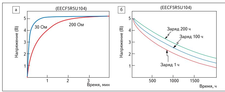
Рис. 9. Зависимость напряжения ионистора от времени заряда при различном сопротивлении (а) и времени разряда при различном временем заряда (б)
