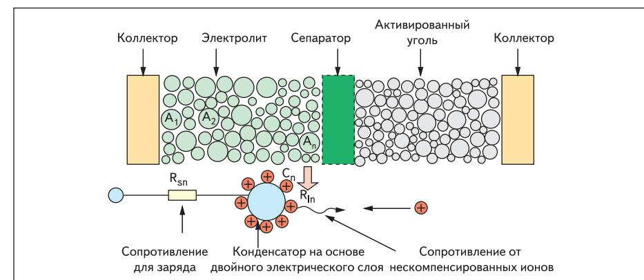
Рис. 4. Схематическое изображение многослойной структуры активированный уголь/электролит
