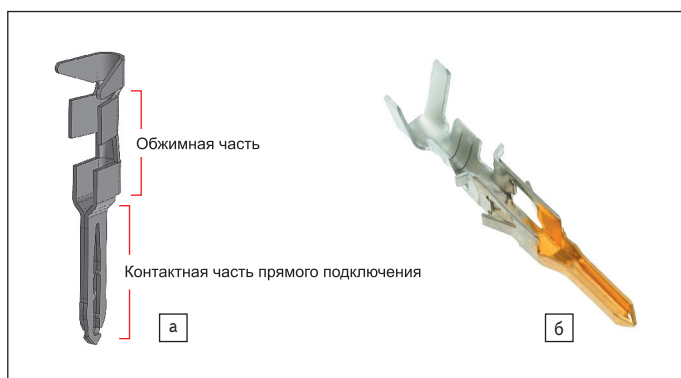
Рис. 2. а) Контакт технологии SKEDD компании Würth Elektronik ICS GmbH & Co. KG для организации подключений wire-to-board;
