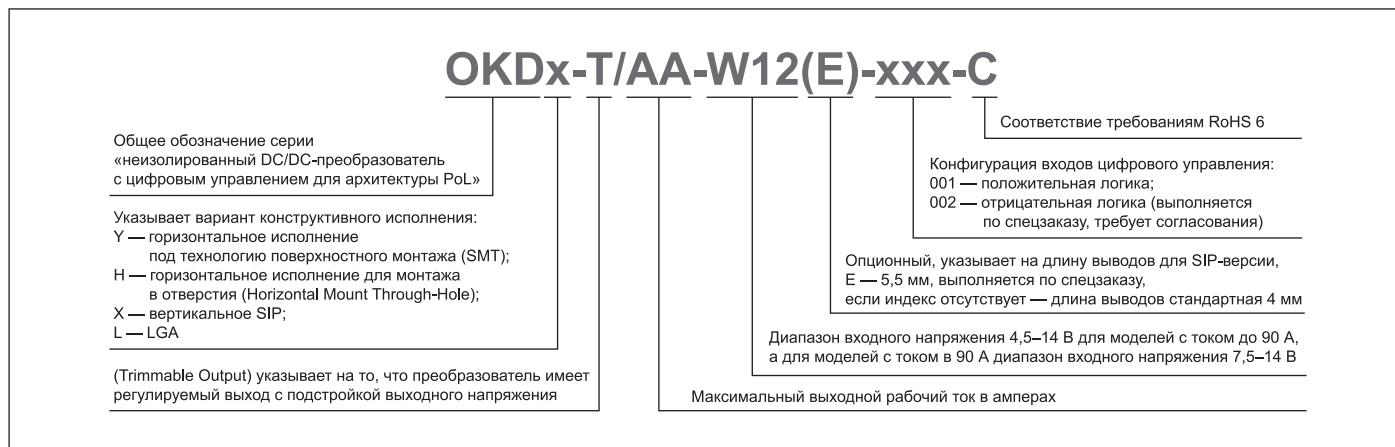
Рис. 2. Символика, принятая в наименованиях DC/DC-преобразователей серии OKDx-T/AA-W12(E)-xxx-C
