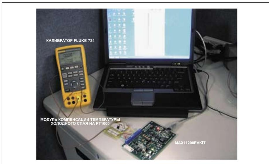
Рис. 7. Отладочная система
