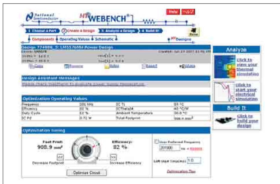
Рис. 9. Окно программы WEBENCH при проектировании импульсного стабилизатора на ИМС LM5576
