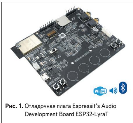
Рис. 1. Отладочная плата Espressif's Audio Development Board ESP32-LyraT
