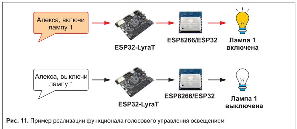
Рис. 11. Пример реализации функционала голосового управления освещением
