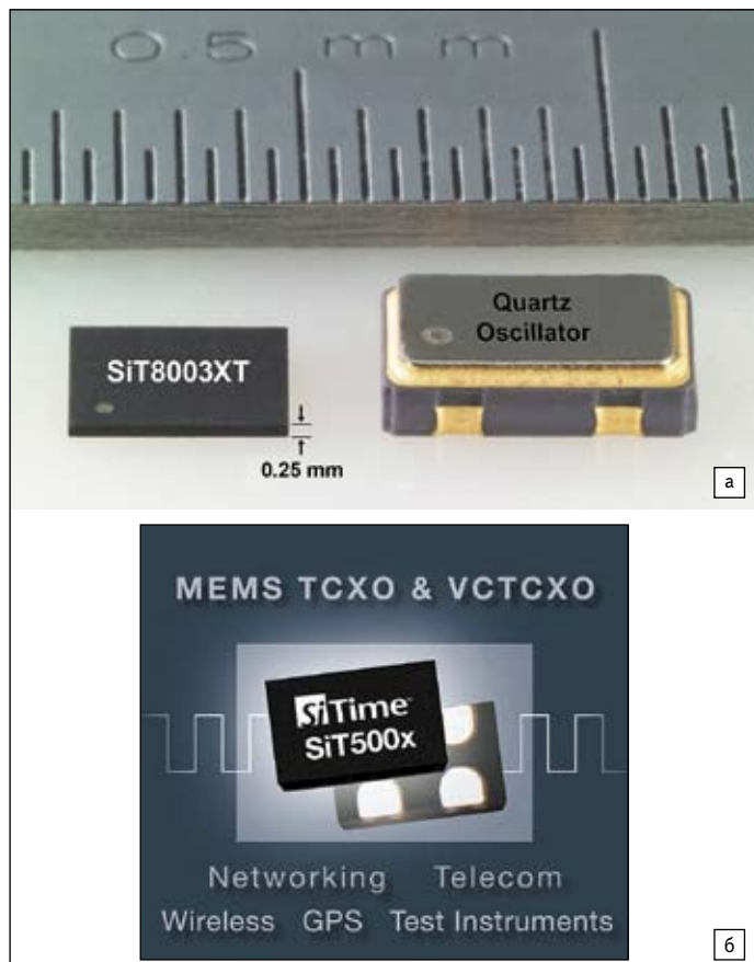
Рис. 4. Кремниевые MEMS-осцилляторы SiTime: а) сравнение размеров корпусов кварцевых кристаллов и SiT8003XT; б) новое программируемое семейство ультрастабильных осцилляторов VCTCXO SiT500x
