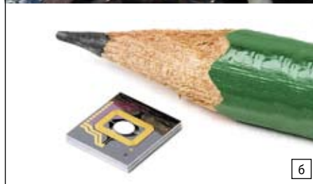
Рис. 1. а) Иллюстрация лазерной сканирующей технологии MicroVision PicoHUD; б) применения микрозеркального MEMS-устройства в PicoP
