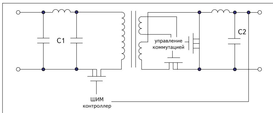
Рис. 1. Пример электрической схемы изолирующего DC/DC конвертора
