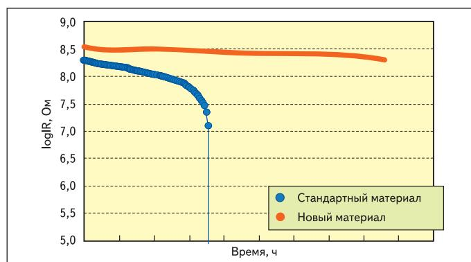
Рис. 5. Результаты ускоренных высокотемпературных испытаний под нагрузкой (20 В/мкм, 105 °C)
