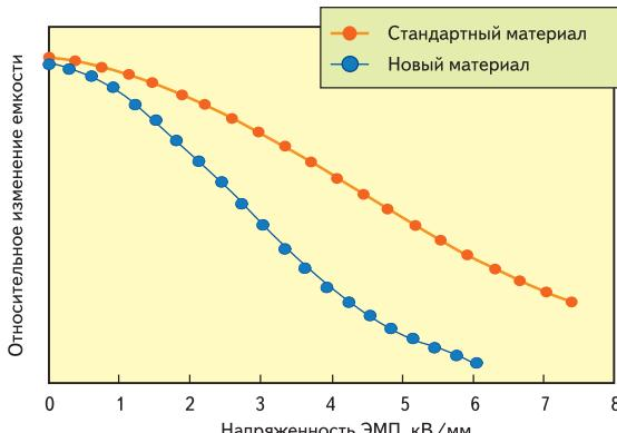
**Рис. 6.** Нормированное при 85 °C относительное изменение емкости при увеличении напряженности электромагнитного поля (по отношению к значениям при 20 °C)
